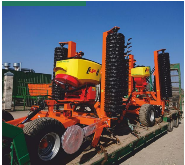
Modernizacja wału Vaderstad Carrier Montaż APV PS800 na wałach up
