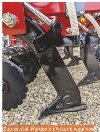
Ząb ze stali Hardox z płytkami węglowymi
